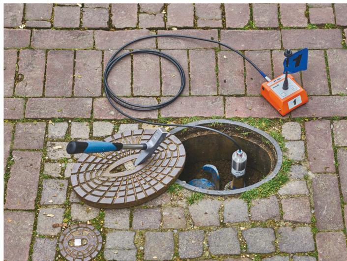
Émetteur radio **RT 200** utilisé avec un microphone **UM 200**
