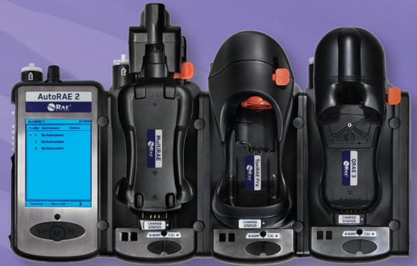
Le système automatique de test et d'étalonnage AutoRAE 2 pour les détecteurs portables de RAE Systems permet de répondre aux exigences d'étalonnage et de test des matériels grâce à un seul bouton. Il suffit de poser le détecteur sur le socle et le système effectue l'étalonnage, les tests et la recharge de la batterie.
