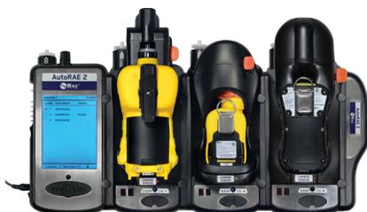
Un système AutoRAE 2 configuré avec un contrôleur et trois socles pour les moniteurs à pompe ToxiRAE Pro, QRAE 3 et MultiRAE.
